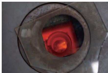
燃やした薪の木質ガスと空気を攪拌させ、高温を発生させるサイクロンチューブ。耐久性に優れ、ワンタッチで交換可能。
